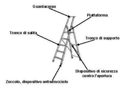
Per utilizzare la scala del tipo sopra descritto, essa deve conservare i requisiti di sicurezza previsti ovvero, avere dispositivi antisdrucciolo per evitare spostamenti e scivolamenti della scala ed essere dotata di dispositivo idoneo contro l'apertura. Inoltre, si ricorda che la piattaforma deve essere utilizzata solamente come piano di appoggio, è consentito salire solo fino all'ultimo gradino e non sulla piattaforma.
